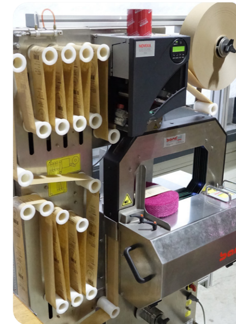
La macchina Bandall è collegata al sistema di magazzino che assicura il processo di fascettatura.
